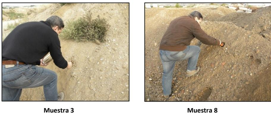
**Figura 7. Toma de muestras de material de rechazo (precibado) de hormigón y mezcla hormigón-cerámicos para determinación de parámetros orgánicos (BTEX, PCB, aceites minerales y HPA)**
