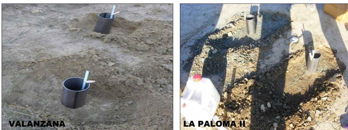
Figura 28. Ensayos para la determinación de la conductividad hidráulica in situ en el fondo de los huecos de las canteras Valanzana y La Paloma II por el método de Hatt & Le Coustumer (2008)
