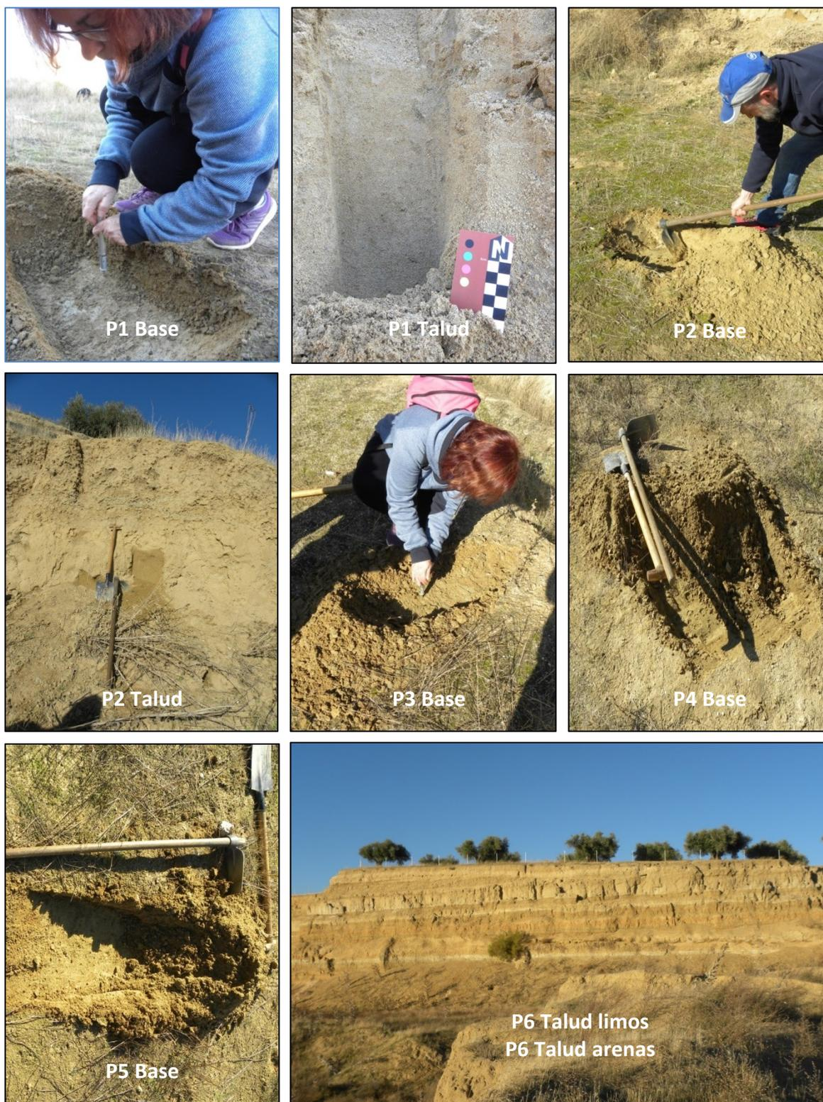
**Figura 2. Puntos donde se realizaron los ensayos de compresión simple y de corte *in situ* en la cantera Valanzana**
