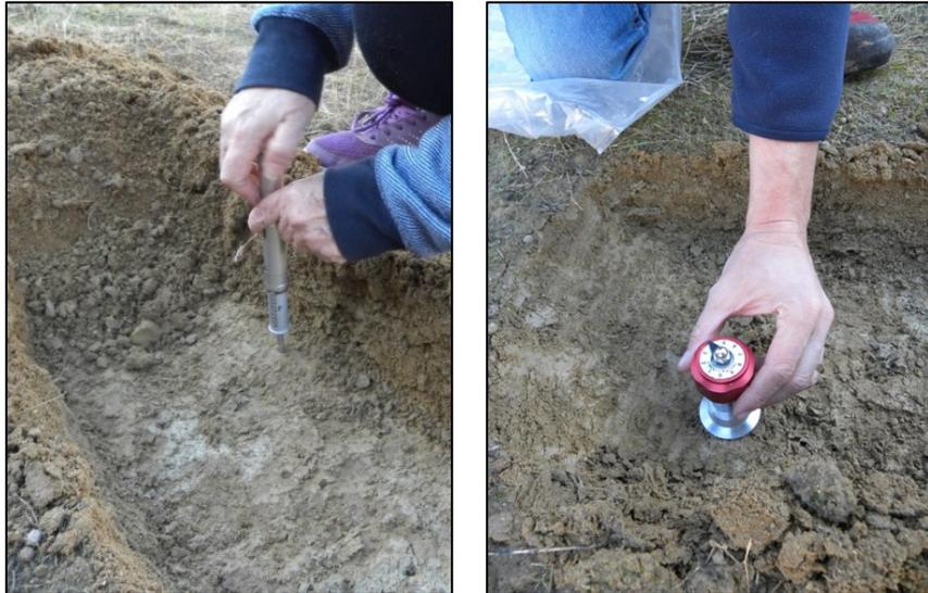
**Figura 36.** Ensayos de resistencia a la compresión simple con penetrómetro de bolsillo de hasta 5 dNA/cm<sup>2</sup> (izquierda) y de resistencia al corte con vane test (derecha) en condiciones no drenadas.:
