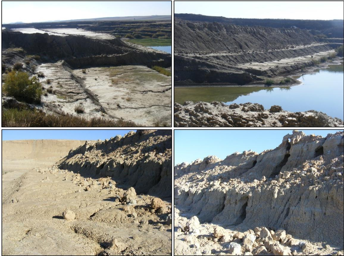
**Figura 33. Erosión de los frentes de avance de la explotación de arcilla en la cantera La Paloma II**
